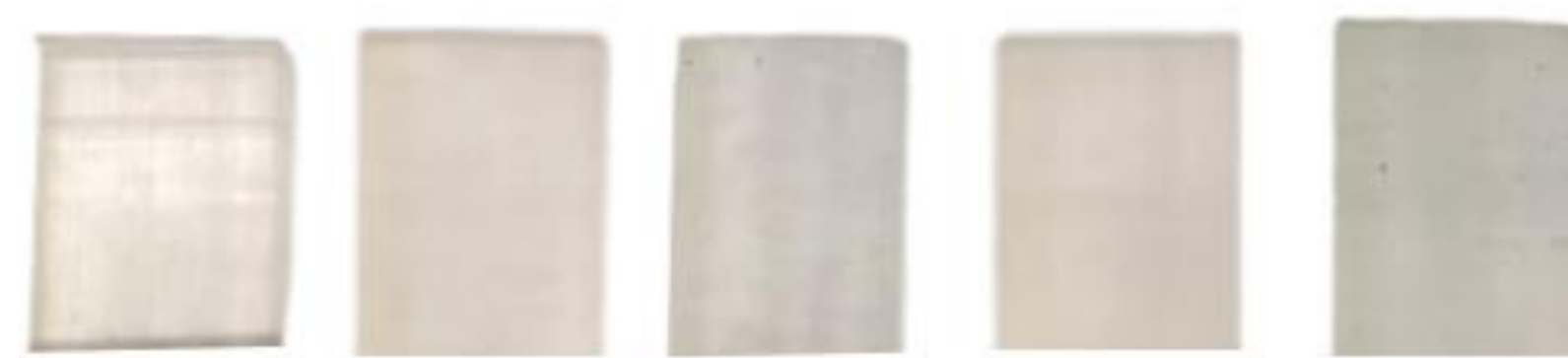
Figura 1 - Amostras nas diferentes concentrações de OG: resina pura, 0.0025% OG importado, 0.0025% OG UCS, 0.0125% OG importado e 0.0125% OG UCS.
